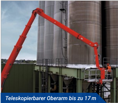
Teleskopierbarer Oberarm bis zu 17 m
