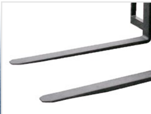
Längere Gabelzinken: 1,00 m – 1,20 m (Standard) 1,50 m – 3,00 m (Optional)
