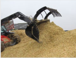
Schaufelgreifer: zum Aufnehmen von loosen Gütern
